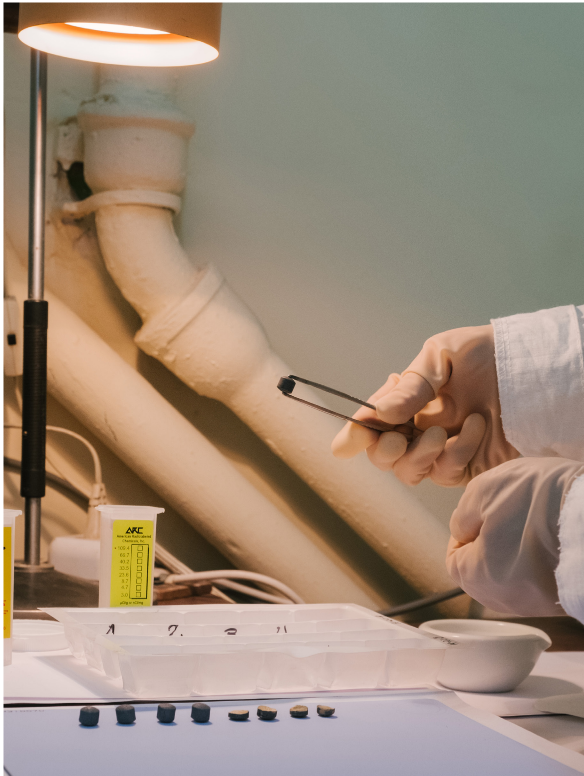
▲ Специалисты ВНИИНМ изучают взаимодействие трития с материалами, из которых будет сделан ИЖСР и его топливо
