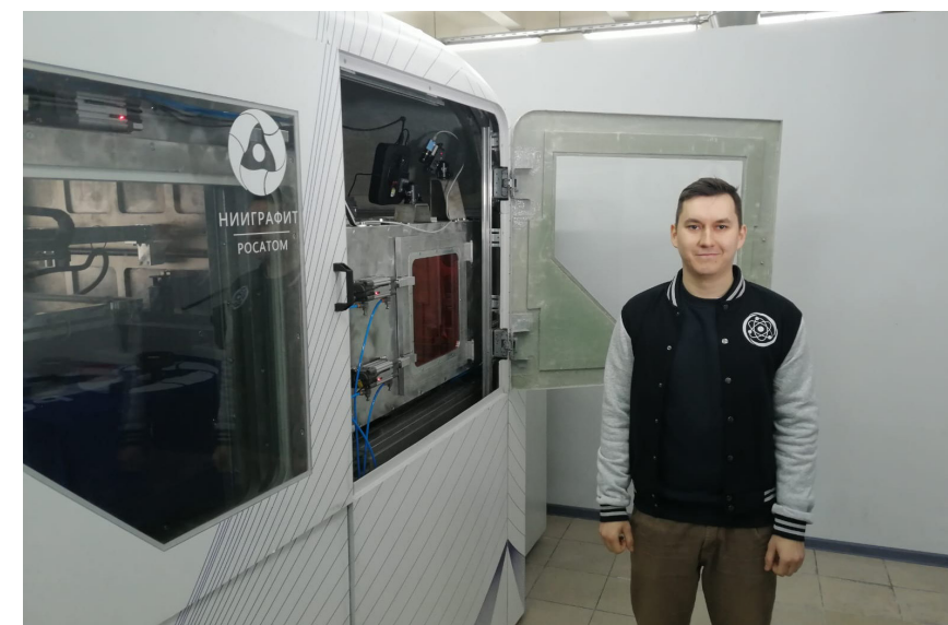
▶ 3D-принтер для печати изделий из керамических материалов
