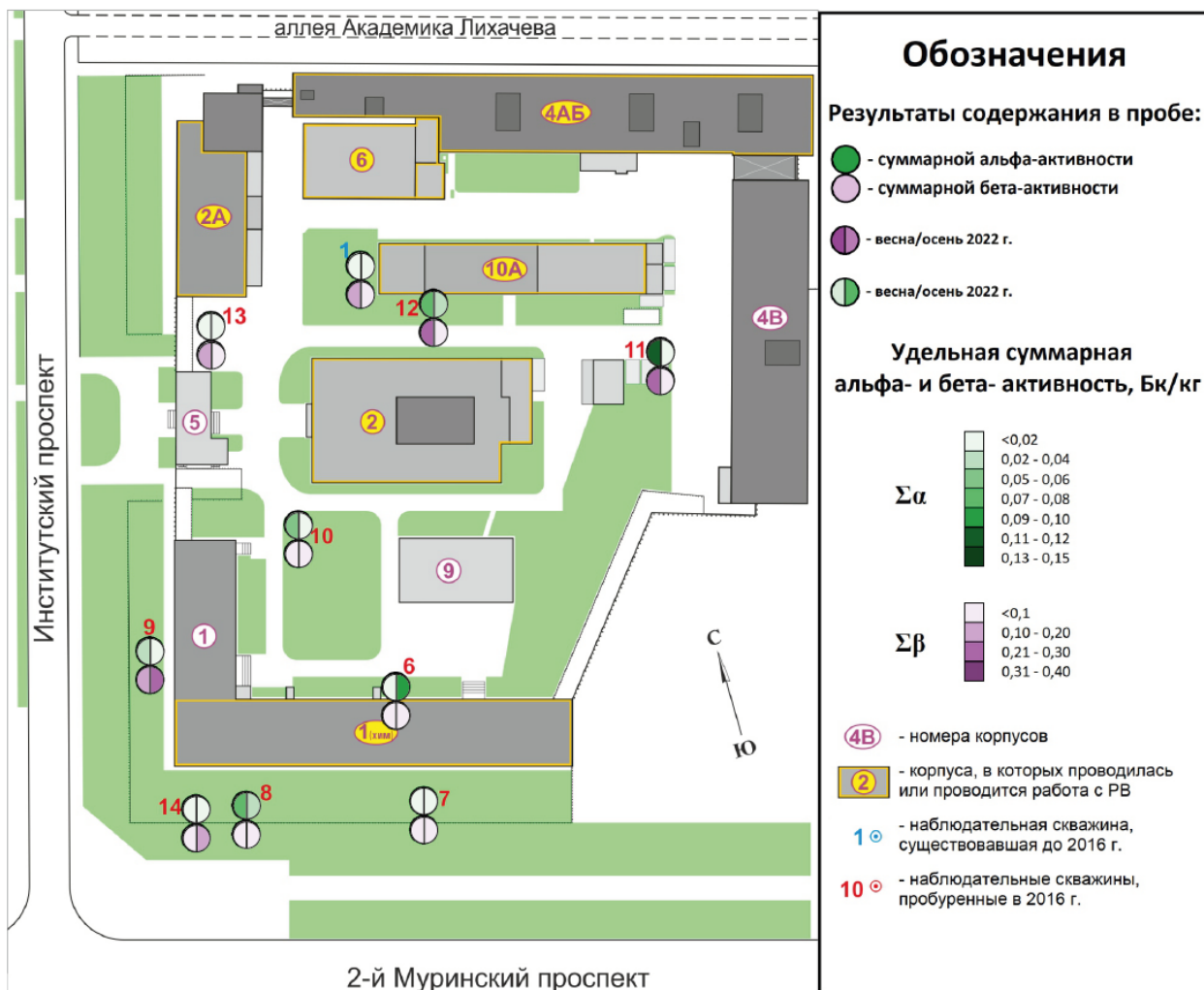
Рисунок 17 – Результаты измерений суммарной альфа- и суммарной бета-активности в подземных водах скважин площадки № 1 в 2022 г.
