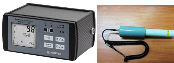
Рисунок 8 – Дозиметр-радиометр МКС-АТ1117М и блок детектирования рентгеновского и гамма-излучения БДКГ-03
