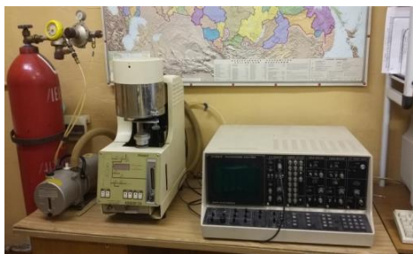
Рисунок 14 – Спектрометр альфа-излучения Numelec 114
