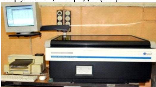
Рисунок 16 – Жидкостно-цинтилляционный радиометр TriCarb 3100TR
