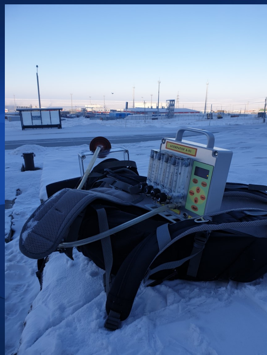
Фото 2. Инструментальные замеры концентраций загрязняющих веществ в атмосферном воздухе
