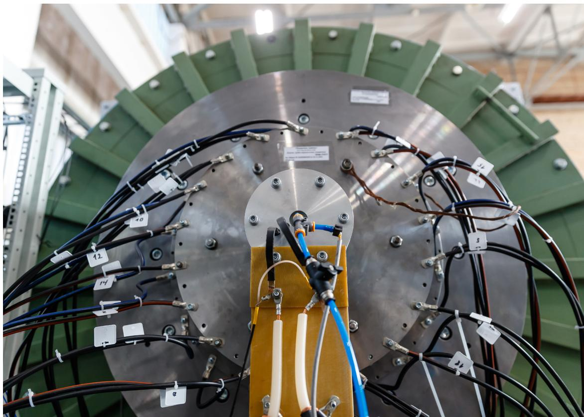
▲ Прототип магнитно-плазменного ускорителя с удельным импульсом не менее 100 км/с с вакуумной камерой
