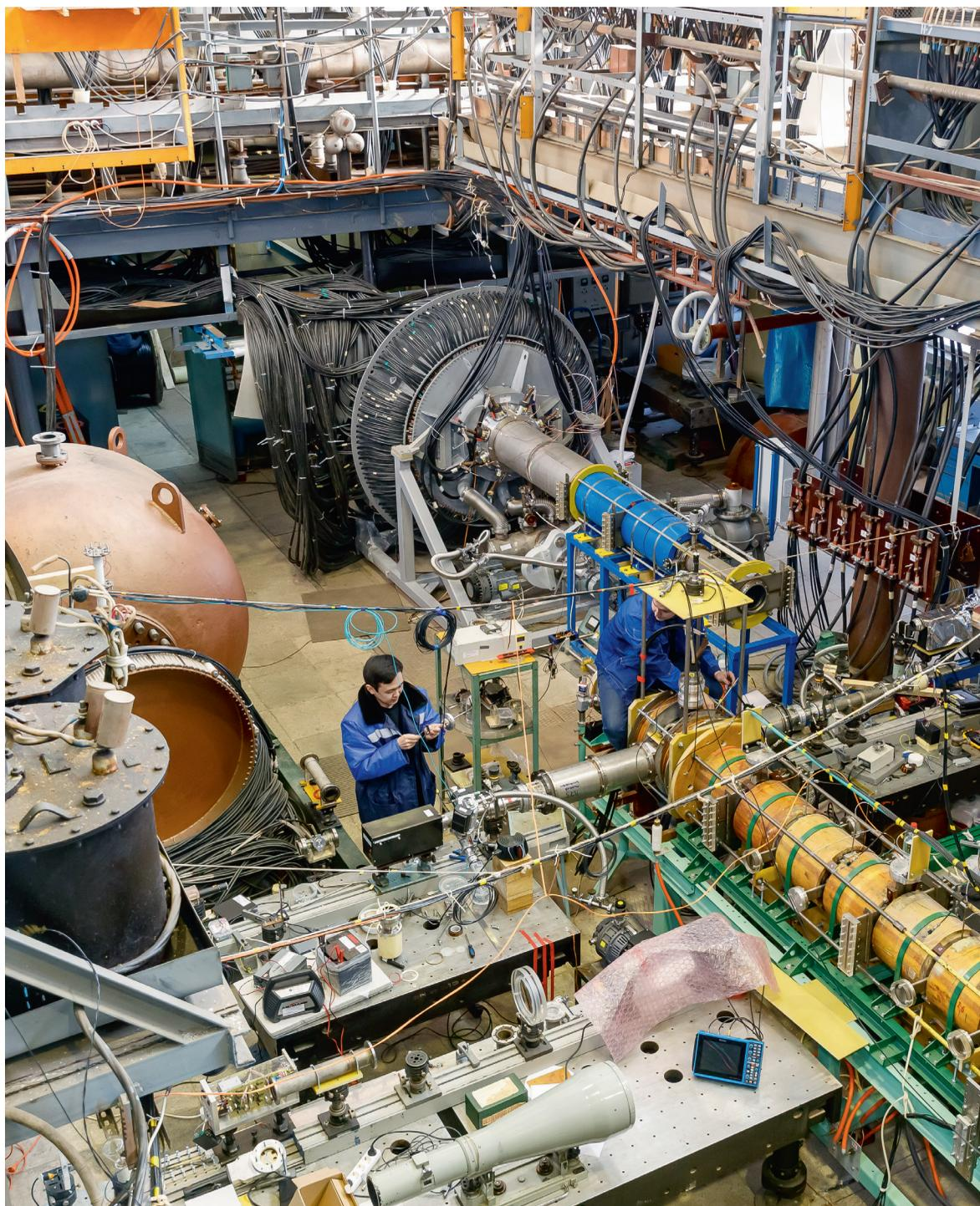
▲ В ГНЦ РФ ТРИНИТИ создается мощный нейтронный источник на основе столкновения плазменных сгустков. На снимке – первый ускоритель системы. Позже в ней будет два ускорителя, «стреляющих» пучками плазмы навстречу друг другу. При столкновении пучков будут происходить реакции ядерного синтеза с выходом высокоэнергичных нейтронов. Основное применение источника — испытание материалов для термоядерного реактора
