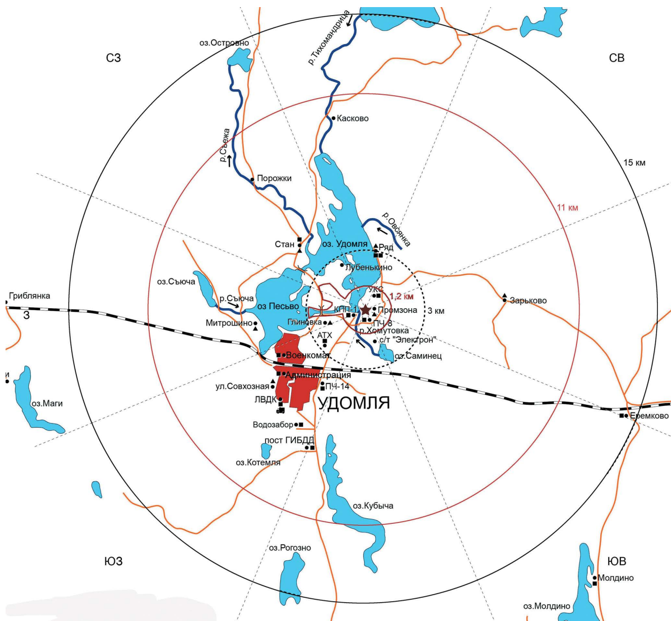
Рис. 5.2. Схема постов радиационного контроля, санитарно-защитная зона и зона наблюдения Калининской АЭС.
