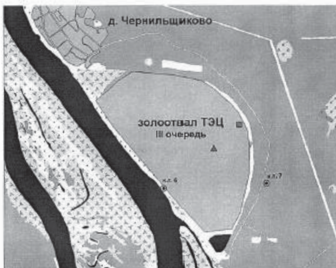
Б.2 - Схема расположения мест отбора проб приземного атмосферного воздуха, подземных вод и почвы в районе расположения золоотвала III-й очереди
