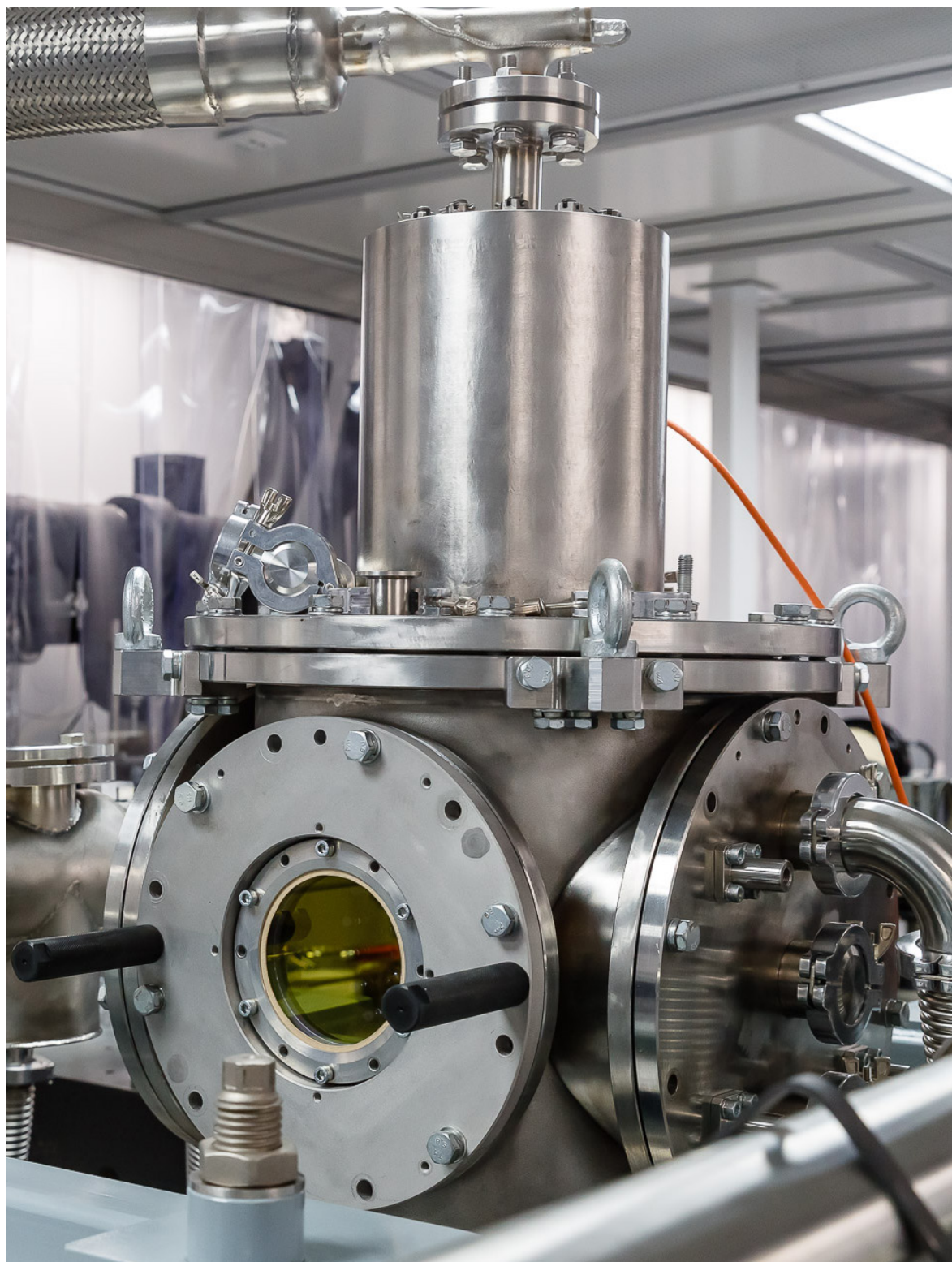
▲ Макет экспериментального образца усилительного модуля (в центре). Это камера, обеспечивающая крепление активного элемента (ключевая часть лазера) и его охлаждение
